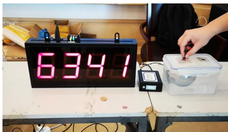
图 12 完整的黑体辐射演示系统
