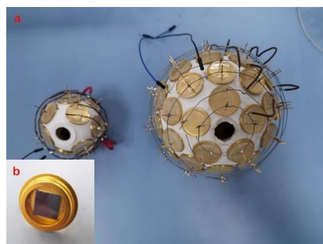
图 9 贴满光电池的空腔
